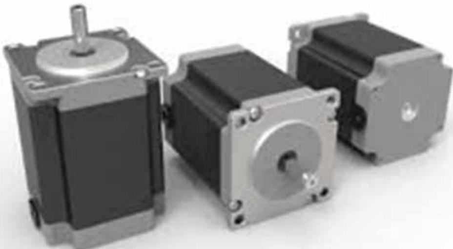
استپ موتور که به نام موتور پله ای هم شناخته می شود یک دور کامل را به تعدادی استپ یه پله تقسیم میکند. استپ موتور به دلیل وجود این استپ ها توانایی حرکت گستره یا پله به پله را دارد. استپ موتور با پالس هایی که دریافت می کند فعالیت میکند همچنین هر پالس موتور را تا زاویه ای مشخص حرکت می دهد
